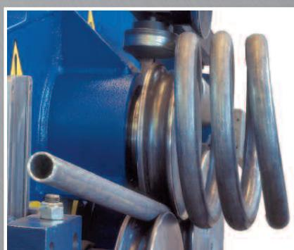
Estensione guida laterale per spirali di piccolo diametro. Rulli sagomati per tubo.
